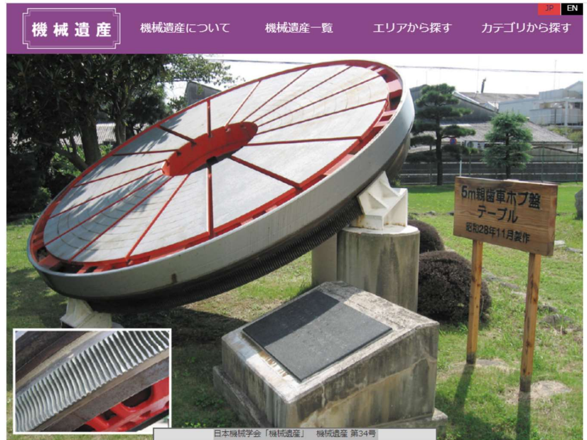
機械遺産登録 船舶用タービン親歯車ホブ盤(1953年) 7 th φ5000 累積ピッチ4um 世界最高精度
