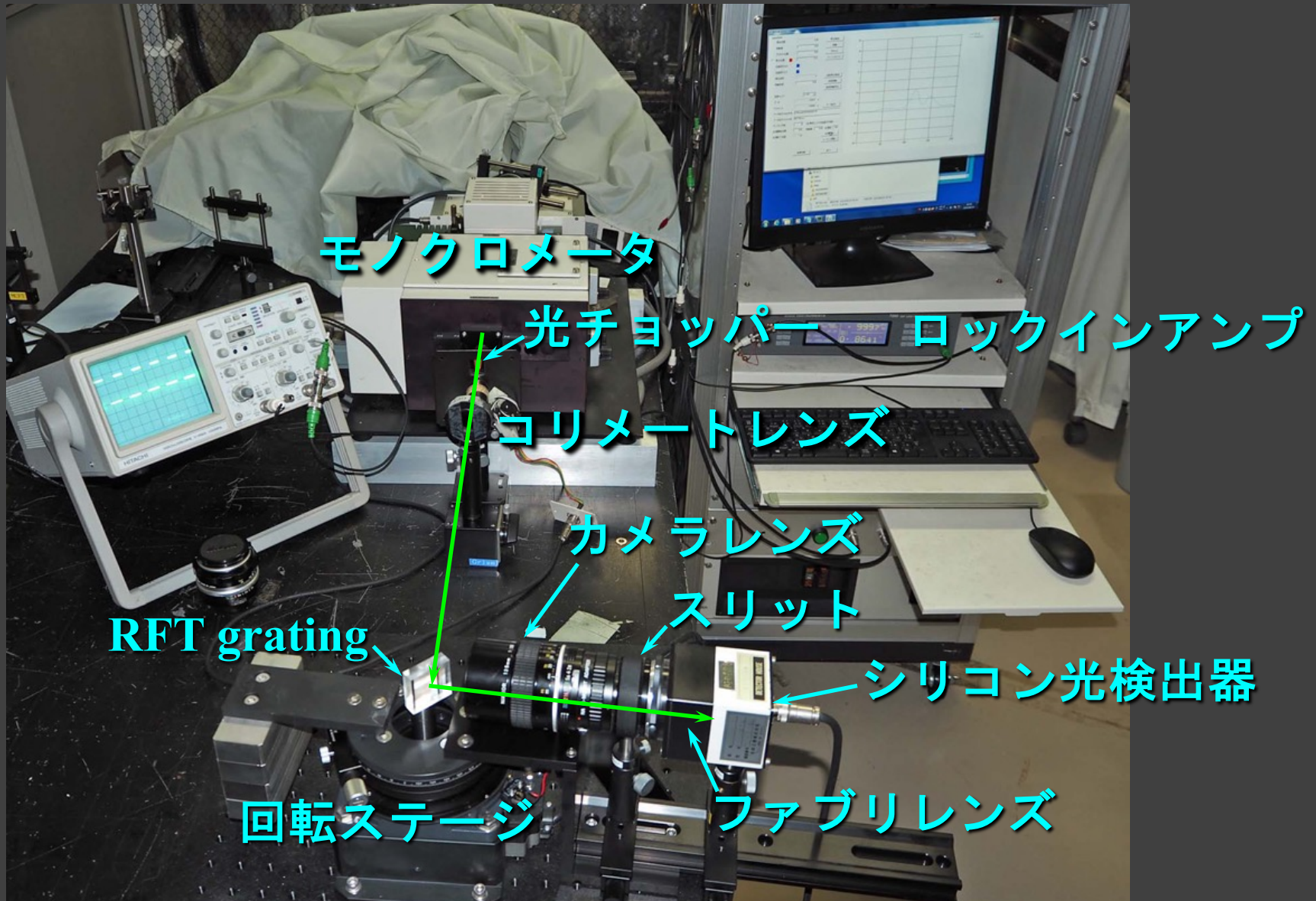
回転テーブルの回折効率測定システム
